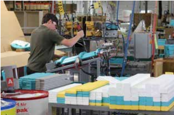
Un empleado operando una máquina automática de tornillos en una línea de ensamblaje de muebles.
