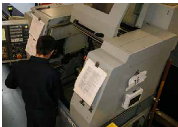
Configurando una máquina Star SR-20R-II con capacidad para diámetros de 20 mm, la cual se utiliza para piezas complejas.
