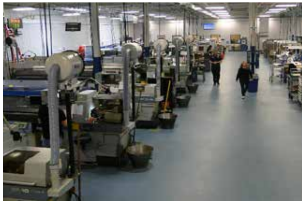
El piso principal del taller, que contiene 27 máquinas de tornos estilo suizas CNC Star.
